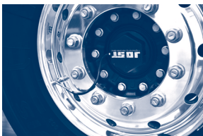
5.4.b. ábra. Levegőcső az agytól a szelepig egy TPRS rendszerben.
