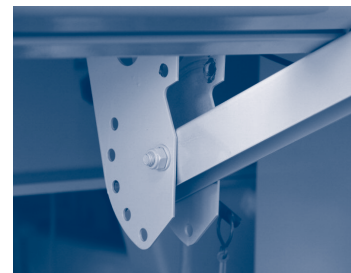
8.2.c. ábra – Felemelt oldal aláfutás gátló
