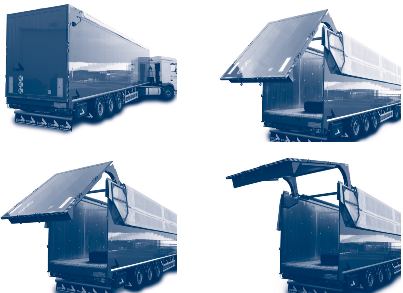
6.2.a. ábra – Hidraulikusan működtethető hátsó függesztett lengőajtó
