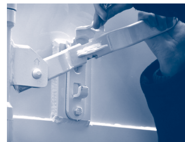
6.1.b. ábra. – Az ajtónyitó karok (bal oldal) és a rögzítő szerkezet
