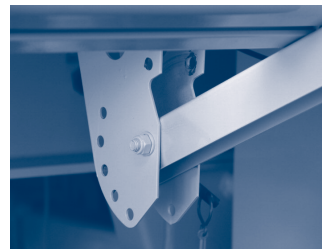
10.3.d.ábra – Felemelve rögzített oldalsó aláfutás gátló
