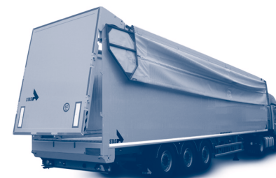
7.3.a. ábra – Nyitott bal oldali részű tetőtakaró háló
