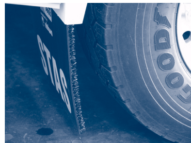
5.4.b. ábra. – Sárvédő gumik fröccsenés gátló kivételben
