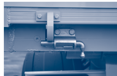
6.2.2.a. – ábra – A lengőajtó-záróhorog biztonsági retesze
