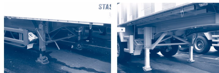
2.1.a. ábra – acél típusú (bal oldali kép) és "alumínium típusú gólyalábak" (jobb oldali kép)
