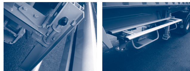
10.3.b. ábra – A biztonsági csapok kinyitása és az aláfutásgátló felhajtása
