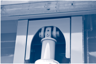
6.a. ábra – A munkahenger kenése
