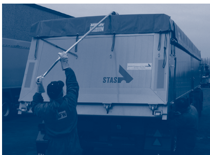
7.3.1.a. ábra – "Dawnbarn" típusú takaróponyva-rendszer
