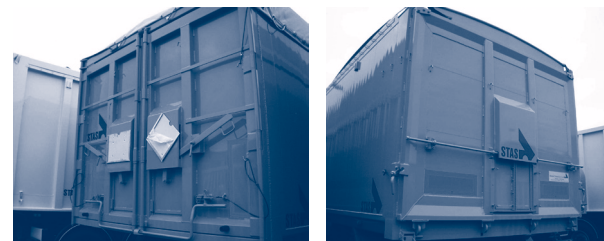
8.2.1.a. ábra – A gabonaablak különböző típusai
