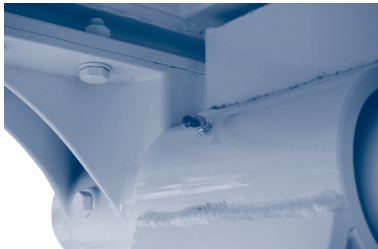
6.c. ábra – A billentő szerkezet csuklópontjainak kenése
