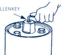
3.2.a. ábra - Munkahenger légtelenítése
