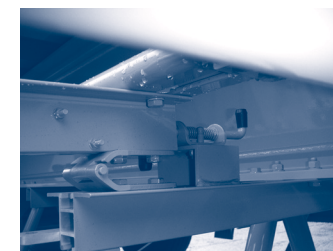
10.3.c. ábra – Oldalsóaláfutásgátlók felhajtva és rögzítve
