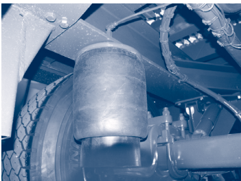
4.1.a. ábra – Lérugós felfüggesztés
