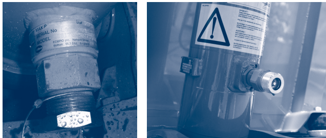
4.1.a.ábra – A munkahenger típus táblája, és a maximálisan megengedett hengernyomás jelölése
