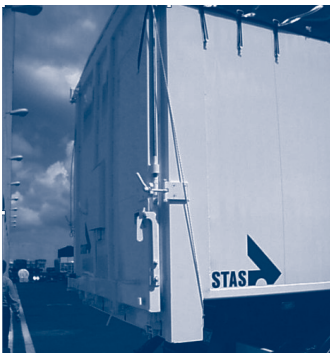
6.4.2.a. ábra – A menetes kulccsal működő horog (zárt állapot)
