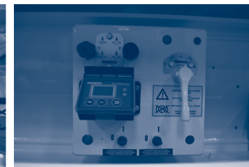
6.2.2.c. ábra – Zárószelep a záróhorog működtetésére egy különálló konzolon
