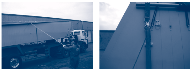
7.3.2.c. ábra – “Dawnbarn” típusú ponyva zárása, a húzó zsinór és a ponyva kifeszítése
