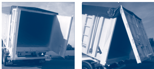
6.3.1.a. ábra – Univerzális ajtó kétszárnyú ajtóként (bal oldali kép) vagy lengőajtóként használva (jobb oldali kép)
