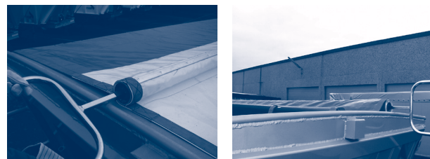
7.3.2.b. ábra – "Dawnbarn" ponyva működtetése kiszolgáló állványról
